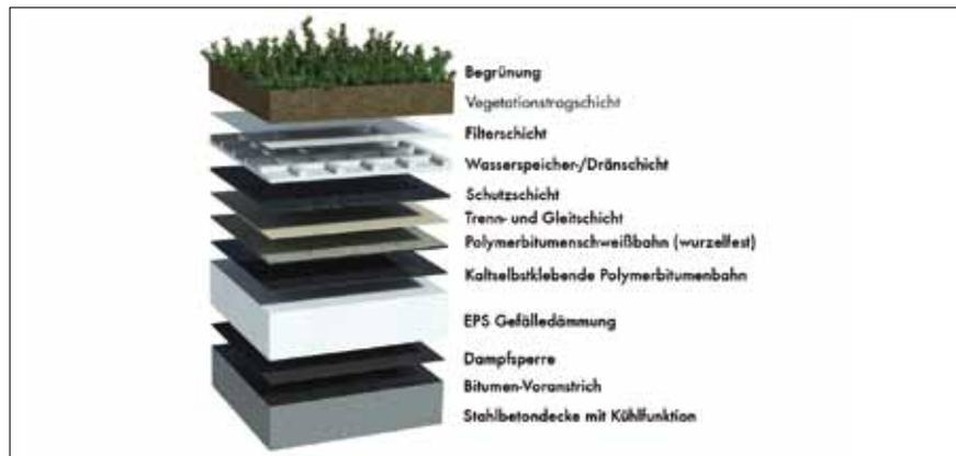
Beispielhafter Schichtenaufbau eines Gründachs.
